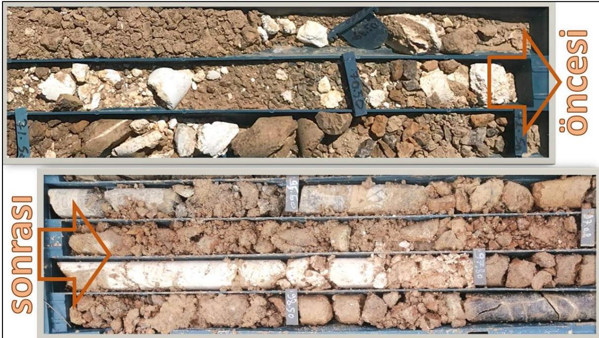
Görsel 1- Karot kalitesinin ve karot veriminin düşük olduğu bir sondaj çalışması ve sonrasında parametrelerin iyi bir disiplin altında uygulanması sonucu karot veriminin ve kalitesinin yükselmesi.
